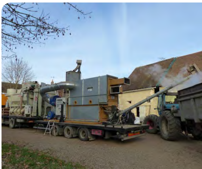
Le toasteur est installé sur camion avec possibilité de tri préalable
